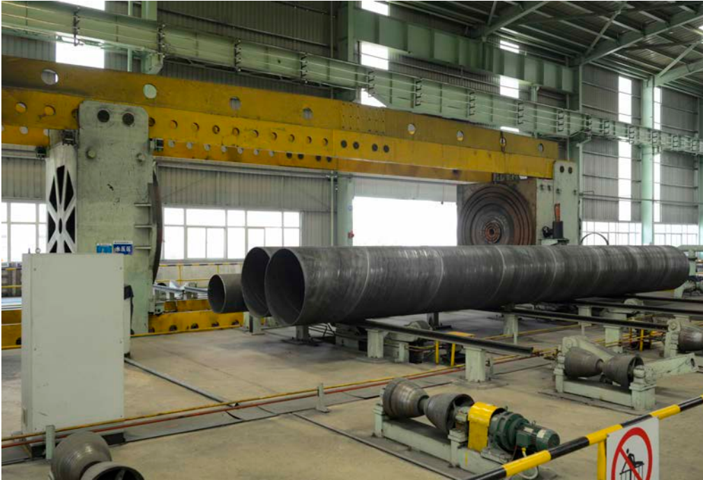
03 水压试验 Water Pressure Test
